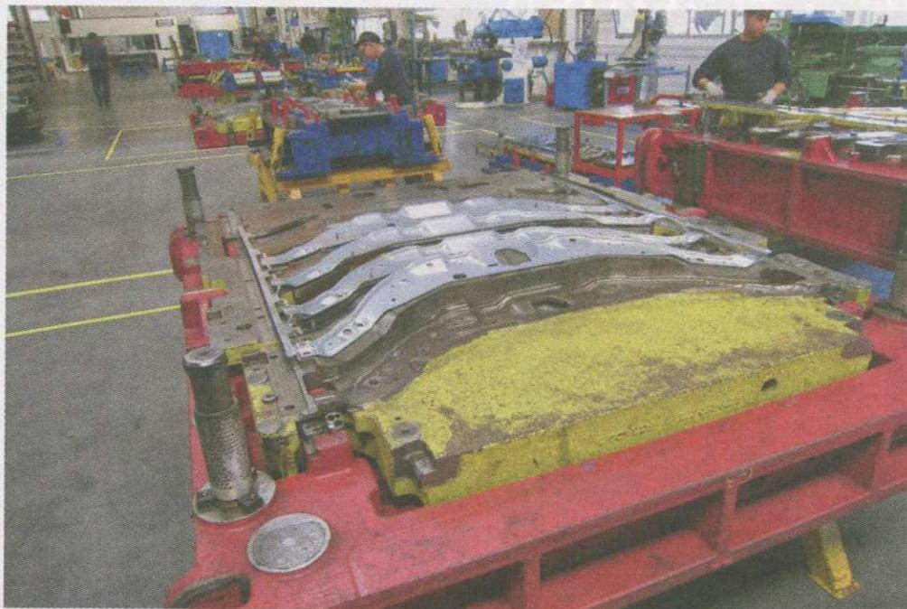
*Snop s'occupe d'emboutissage, une filière encore méconnue au Maroc avant l'arrivée de Renault. Il s'agit d'une opération qui consiste à donner forme à la tôle, des techniques qui nécessitent un savoir-faire très particulier (Ph. Adam)*
