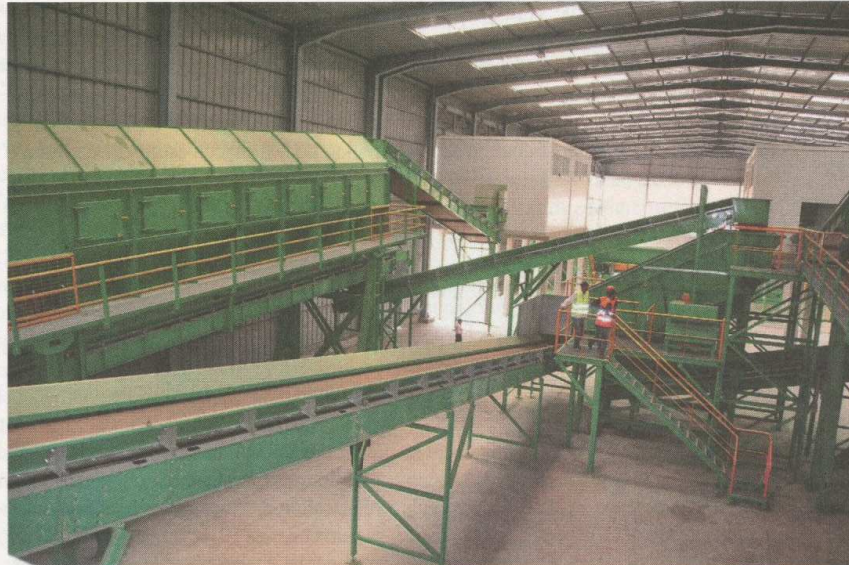
Un centre de valorisation à l'Mnabha qui reçoit les déchets acheminés sur une table de tri puis débarrassés des produits encombrants manuellement. Ces produits triés sont alors dirigés dans des bennes situées sous la charpente de pré-tri. Intervient ensuite le tri mécanisé (Ph. Mokhtari)
