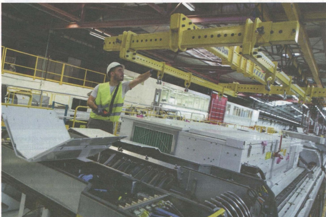
La chaîne de montage à l'usine de La Rochelle n'est pas totalement mécanisée. L'élément humain reste très important pour l'assemblage des différentes composantes d'un tramway: cabine, châssis, roof, museau, bogies ... Plus de 65% du tramway est «made in France». Le reste provient d'autres sites en Pologne, au Maroc ou ailleurs (Ph. Alstom)
