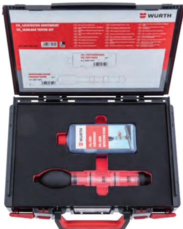
**2 pièces dans un système de rangement à compartiments 4.4.1. Permet au CO<sub>2</sub> contenu d'être mesuré pour une détection anticipée des fuites entre la chambre de combustion et le système de refroidissement des véhicules.**
